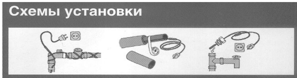
Монтаж внутри трубы.
