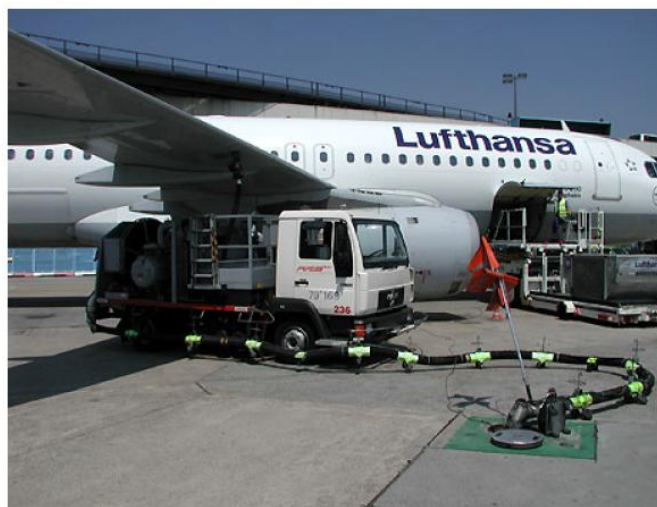
Топливозаправщик, подключенный к топливозаправочному штуцеру под крылом самолета
